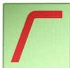
Para el tweeter se utiliza un filtro paso alto. En nuestro ejemplo hemos definido una frecuencia de 2.100 Hz como frecuencia de corte superior. El tweeter de cúpula se acopla a un filtro de segundo orden (12 dB / octava).
