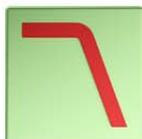
Para el altavoz de medios-graves se utiliza un filtro paso bajo de segundo orden (12 dB / octava) que trabaja con una frecuencia de corte de 1.500 Hz.
