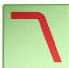
Por medio del filtro paso bajo se bloqueas los sonidos agudos en los subwoofer Asimismo, los subwoofer se acoplan a los altavoces satélite a través de la frecuencia de corte y la pendiente de los filtros.
