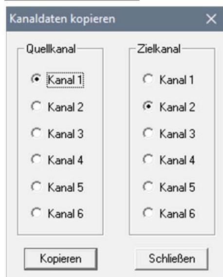
La configuración de los canales se puede editar mediante una función de copiado. Para hacerlo hay que ir a la opción de menú > *Bearbeiten* (editar), seleccionar allí > *Kanal kopieren* (copiar canal), hacer clic en el número deseado del canal de origen (Quellkanal), en la columna izquierda, y seleccionar en la columna derecha el canal de destino (Zielkanal). Tras ello se debe pulsar consecutivamente los botones „Kopieren“ (copiar) y „Schließen“ (cerrar)
