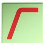
Para el tweeter se utiliza un filtro paso alto. En nuestro ejemplo hemos definido una frecuencia de 2.100 Hz como frecuencia de corte superior. El tweeter de cúpula se acopla a un filtro de tercer orden (18 dB / octava).
