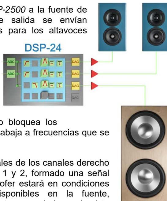
Mediante los módulos de delay, los ecualizadores y la regulación de volumen los componentes se puede armonizar entre sí los componentes y adaptarlos, además, a la sala de escucha.
